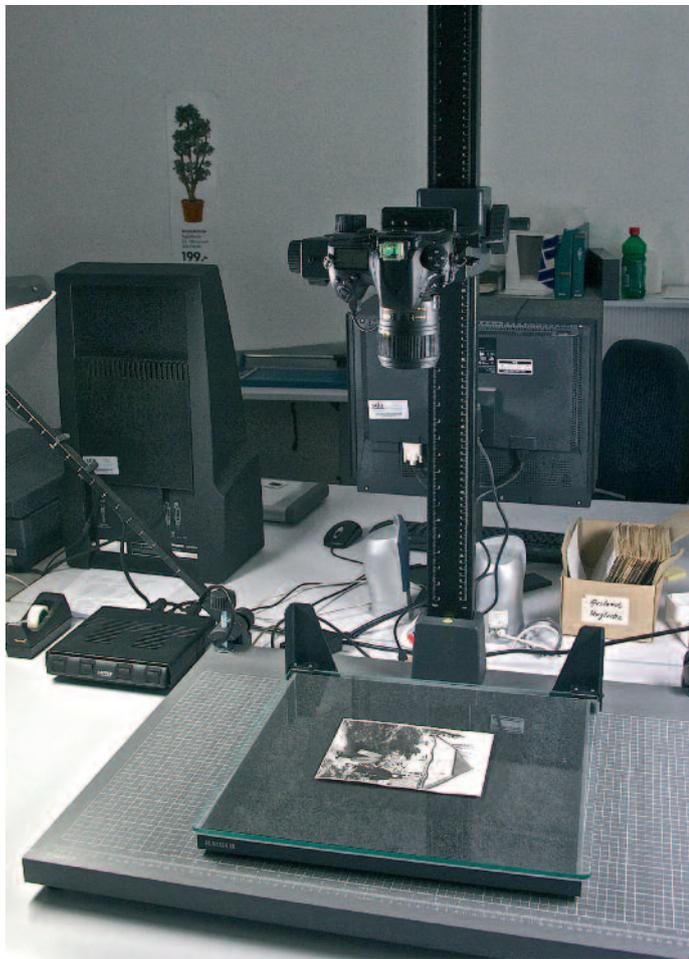
Erinnert zwar an den Aufbau einer klassischen Vertikal-Reprokamera, ist aber um Dimensionen kleiner: Stativ, Vorlagenhalter und die Spiegelreflexkamera Nikon D800E. Der Scanner links im Bild hat mehr oder weniger ausgedient, seit Keystone im April 2012 auf die Digitalfotografie auch im Bereich der Bildreproduktion umgestiegen ist. Dabei bewältigt die D800E alle Aufgaben: Aufsicht, Durchsicht, Schwarz-Weiss und Farbe.
